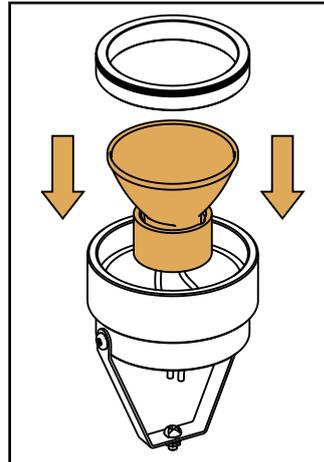
Por último introducir la lámpara en el interior del cuerpo y ajustar el aro sujetador.
